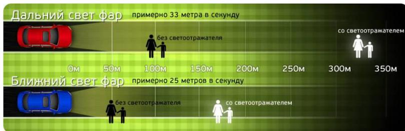
Как наглядно видно из рисунка, передвигаясь в темное время суток с ближним светом фар, водитель видит пешехода только на расстоянии не более 50 метров (около 30 м. в реальности), а пешехода со светоотражателем – почти на 150 м. При движении с включенным дальним светом водитель замечает пешехода на расстоянии меньше 100 м. (а ведь это очень мало, например, для трассы), пешехода со светоотражателем водитель видит уже на расстоянии 300 метров.
